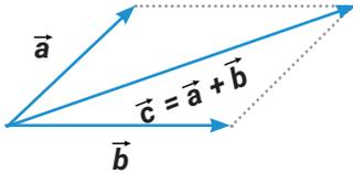
**2 способ. Правило треугольника.** Возьмем векторы  $\vec{a}$  и  $\vec{b}$ . К концу первого вектора пристроим начало второго. Соединим начало первого и конец второго. Это и есть сумма векторов  $\vec{a}$  и  $\vec{b}$ .
