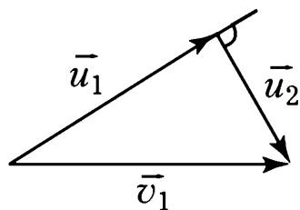
Изобразим закон сохранения импульса (после сокращения  $m$ ) на рисунке. Из закона сохранения энергии следует, что стороны треугольника скоростей подчиняются теореме Пифагора. Значит, угол между скоростями  $\vec{u}_1$  и  $\vec{u}_2$  равен  $90^\circ$ .
