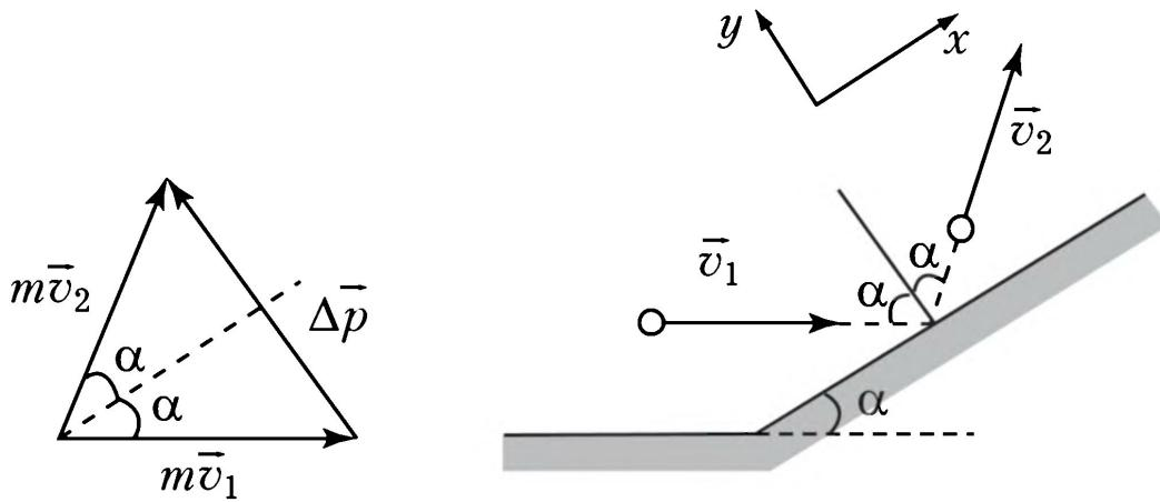
Поскольку действием силы тяжести за время удара пренебрегаем, средняя сила, которой плоскость при ударе действует на шарик, равна
