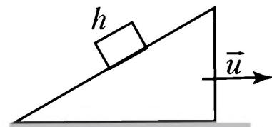
Так как система брусков-клинов замкнута в проекции на горизонтальное направление, то горизонтальная проекция импульса системы сохраняется
