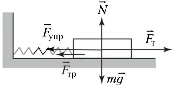
(ускорение равно нулю) и формулы для сил трения и упругости
