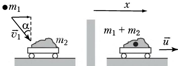
счет силы тяжести:  $m\bar{g}\Delta t \rightarrow 0$ . Единственной внешней силой, действием которой пренебречь нельзя, остается сила нормальной реакции со стороны наклонной плоскости. Если направить ось  $x$  вдоль плоскости, то проекция силы реакции на эту ось обратится в ноль, т. е. проекция импульса системы на это направление сохраняется
