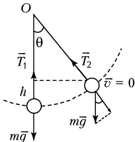
**Задача 22.** Какую минимальную горизонтальную скорость надо сообщить шарику, чтобы он сделал полный оборот в вертикальной плоскости, если он висит на легкой нерастяжимой нити длиной 2 м?  $g = 10 \text{ м/с}^2$ .
