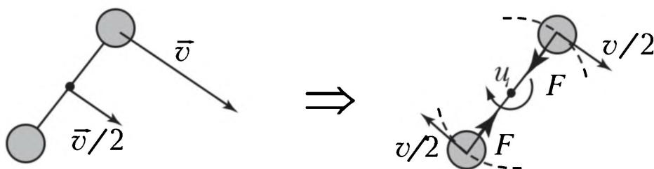
Поскольку система замкнута, центр масс системы (находящийся в середине нити) движется равномерно и прямолинейно. Его скорость можно найти из движения шариков в данный момент времени: она параллельна скорости движущегося шарика и равна половине его скорости (см. формулу (24)). Перейдем в инерциальную систему отсчета, движущуюся поступательно со скоростью центра масс. В этой СО центр масс неподвижен, а шарики движутся по окружностям радиусом  $l/2$  со скоростью  $v/2$ . Получаем
