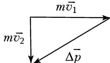
**Задача 3.** Стальной шарик массой 0,1 кг падает на горизонтальную плоскость с высоты 0,2 м и отскакивает после удара снова до высоты 0,2 м. Найдите среднюю силу давления шарика на плоскость при ударе, если его длительность 0,04 с.  $g = 10 \text{ м/с}^2$ .
