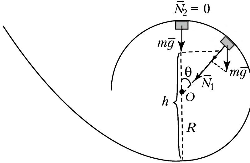
При минимальной энергии, обеспечивающей прохождение всей петли, сила нормальной реакции в верхней точке обращается в ноль (см. реш. 22). Запишем 2-ой закон Ньютона в проекции на радиус в верхней точке и в точке, где  $N_1 = (3/2)mg$
