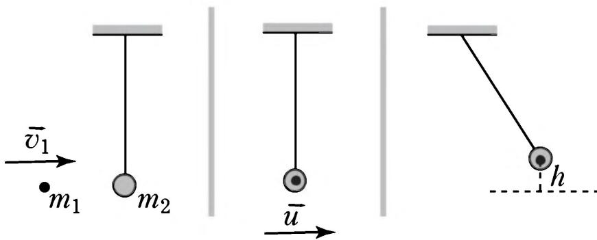
теплота, т. е. часть механической энергии теряется. Чтобы решить задачу, надо рассмотреть шар с пулей сразу после удара. Это промежуточное состояние связано с начальным состоянием законом сохранения импульса
