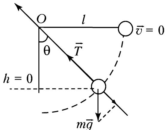
**Задача 21.** На легкой нерастяжимой нити подвешен тяжелый шарик. На какой угол (в градусах) надо отвести нить от положения равновесия, чтобы при последующих качаниях максимальная сила натяжения нити была бы в 4 раза больше минимальной?
